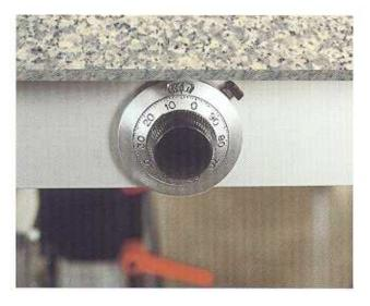
Der TARGOMILL ist eine Target Freifräseinrichtung mit 2 elektrisch angetriebenen Frässpindeln. Die unterschiedlichen Dicken der Aussenlagen werden mittels Plattenabtastung automatisch abgetastet. Somit ist gewährleistet dass bei jeder Plattendicke die voreingestellte Frästiefe automatisch eingehalten wird. Die obere und untere Frästiefe ist über manuelle Einstellräder auf 5/100 mm genau voreinstellbar. Mittels Laserpointer wird das angezeichnete Target manuell zentriert.
